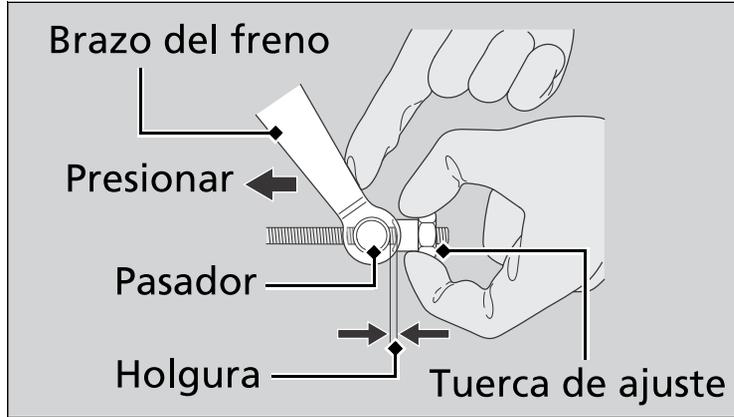
Después del ajuste, confirme el juego libre de la palanca del freno.
