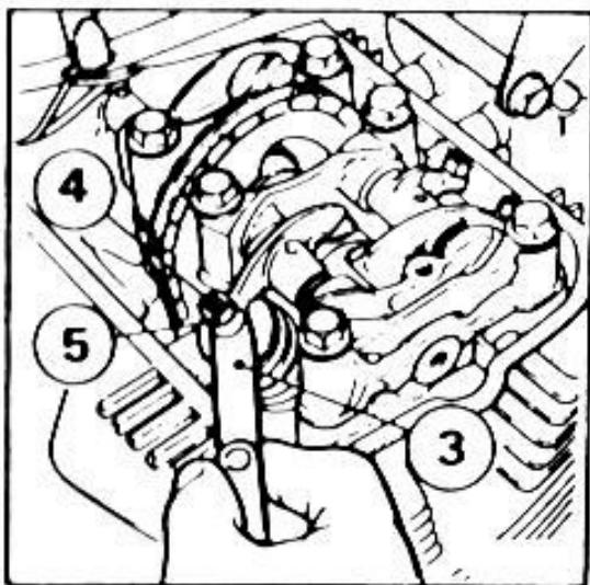
4 – Verifique a folga de ambas as válvulas, introduzindo um calibrador (3) entre o parafuso de ajuste do balancim (4) e a válvula.
