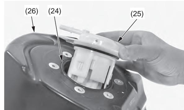
(24) joint torique neuf (26) réservoir de carburant
