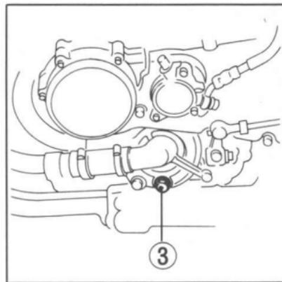
**NOTE: Purger le réfrigérant dans un récipient propre afin de pouvoir le réutiliser. Il est prévu que le réfrigérant soit renouvelé tous les 38.400 km.**
