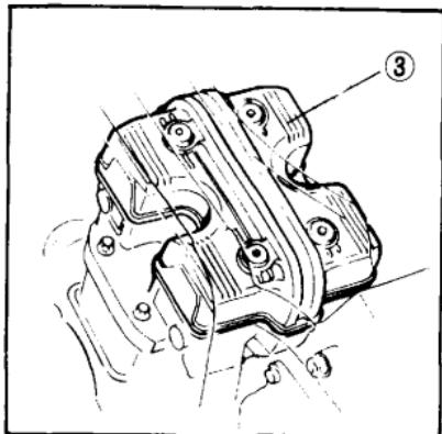
8. Déposer les boulons avant et arrière de couvercles de culasse et déposer les deux couvercles de culasse (3). Déposer le couvercle de l'alternateur.
