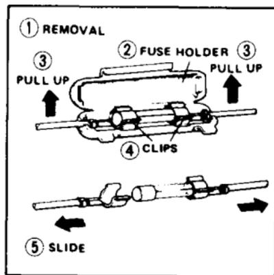
**PRECAUCION:** Desconectar el interruptor de encendido (OFF) antes de verificar o reemplazar los fusibles para evitar cortocircuitos accidentales.
