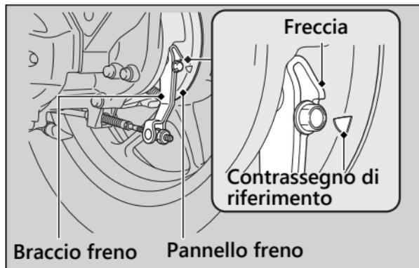
Quando il freno viene azionato, la freccia sul braccio del freno si sposta verso un contrassegno di riferimento sul pannello del freno. Se la freccia si allinea con il segno di riferimento quando il freno viene azionato a fondo, è necessario sostituire le ganasce del freno. Fare eseguire l'intervento presso il proprio concessionario.
