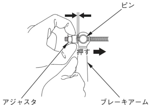
調整後は、ブレーキペダルの遊びを確認してくだ
