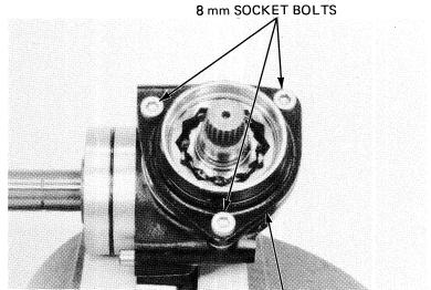
OUTPUT DRIVEN GEAR BEARING HOLDER
