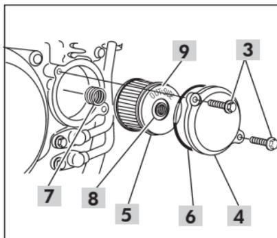
3. Remova os parafusos do filtro de óleo (3) e a tampa do filtro (4). Em seguida, retire o filtro de óleo (5) da tampa.
