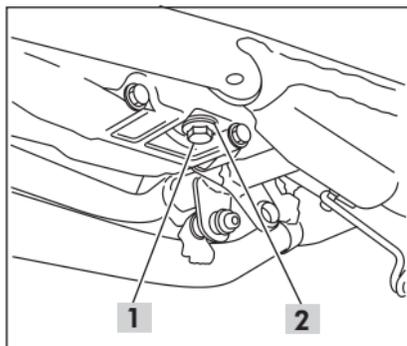
1. Coloque um recipiente sob o motor para coletar o óleo e remova a tampa/vareta medidora, o bocal de drenagem (1) e a arruela de vedação (2).
