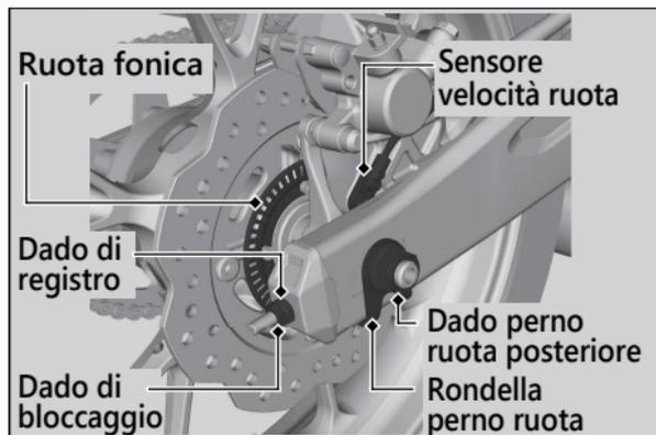
4. Rimuovere la catena di trasmissione dall'ingranaggio condotto spingendo la ruota posteriore in avanti.
