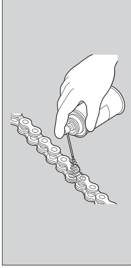
チェーンは、ゴムのシールを使用しているため、スチーム/高圧洗浄、ワイヤーブラシ、ガンリンやベンゼンなどの揮発性溶剤、研磨材が入っている洗剤は使用しないでください。
