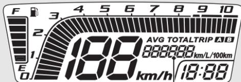
Одометр [TOTAL], счетчик пробега за поездку [TRIP A/B]/ Остаток пробега по топливу/указатель расхода топлива
