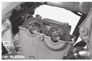
(5) cam sprocket bolt
