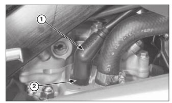
(1) SPARK PLUG CAP (2) SPARK PLUG
