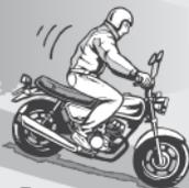
Rilasciare la manopola dell'acceleratore e azionare contemporaneamente il freno anteriore e posteriore.
