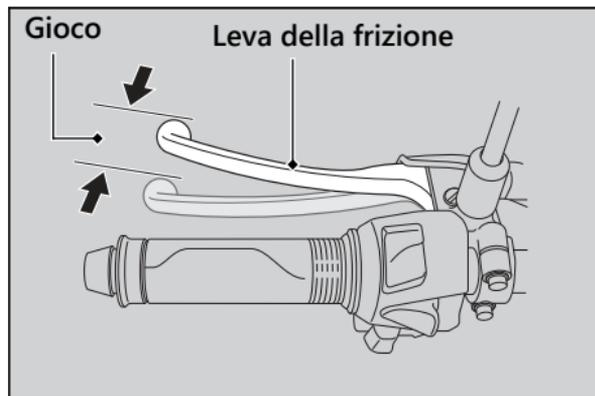
Controllare che il cavo della frizione non sia piegato o logoro. Se necessario, farlo sostituire dal concessionario.
