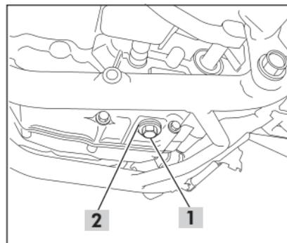
1. Coloque um recipiente sob o motor para coletar o óleo e remova a tampa/vareta medidora, o bujão de drenagem (1) e a arruela de vedação (2).
